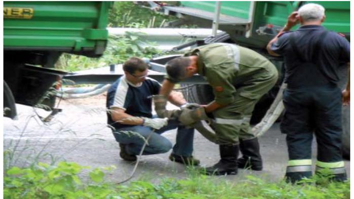
Sicherung der Zweiachskipper mittels Endlosschlingen und der Seilwinde des RLF A 2000
